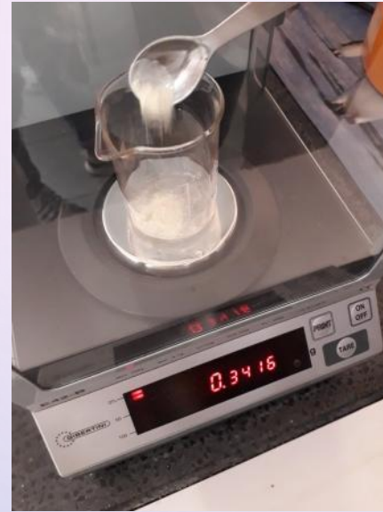
Pesata dei terreni liofilizzati e loro dissoluzione alla fiamma.
