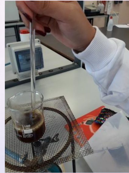
Pesata dei terreni liofilizzati e loro dissoluzione alla fiamma.
